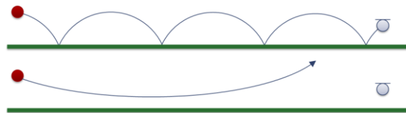
Abbildung 2 Schallstrahlen bei ‚Mitwind‘ (oben) und bei ‚Gegenwind‘ (unten)
